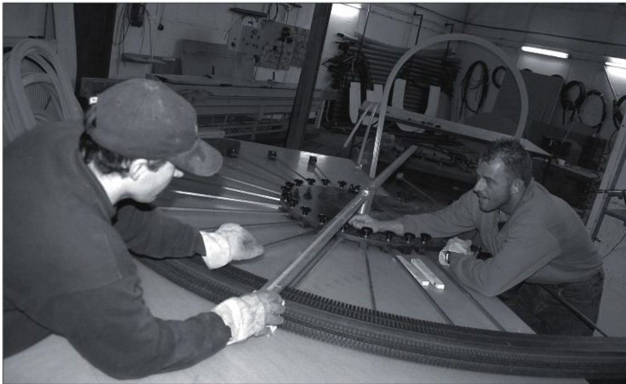
Für das exakte Biegen der Fensterprofile gibt es keine maschinelle Alternative zur Handarbeit. ■ Fotos: Andreas Nöthen
